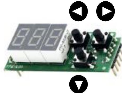
**MUY IMPORTANTE:** antes de conectar o desconectar el PR AP, desenchufar el conector de alimentación. Una vez posicionado el programador en los slots frontales de la central, conectar de nuevo la alimentación
