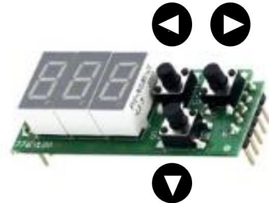
**MOLTO IMPORTANTE:** prima di collegare o scollegare il PR AP, staccare il connettore di alimentazione. Una volta posizionato il programmatore negli slot, ricollegare l'alimentazione
