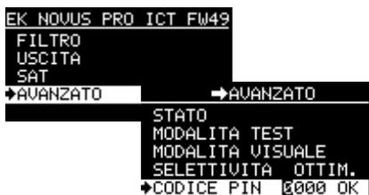
**Nota:** Se dimentichi il PIN per accedere ai controlli del pannello di controllo, dovrai forzare un RESET. Per fare ciò, scollegare il pannello di controllo dalla rete elettrica quindi ricollegarlo tenendo premuto il pulsante centrale per alcuni secondi. Si noti che questa procedura eliminerà tutte le impostazioni salvate in precedenza.
