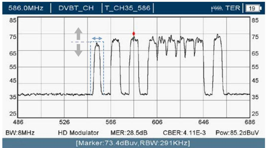
**Regolazione della frequenza di uscita (filtro selezionato):** Utilizzando i pulsanti laterali sul joystick, l'installatore può modificare la frequenza di uscita del filtro selezionato. Per confermare le modifiche, è necessario premere il pulsante centrale sul joystick.
