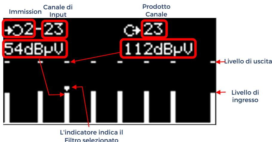
Premendo il pulsante centrale, è possibile accedere direttamente al menu MODIFICA del filtro selezionato utilizzando il marker.
