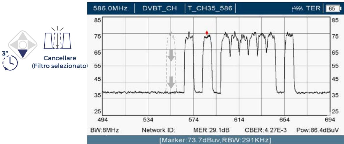
**Creazione di un nuovo filtro:** Tenendo premuto il pulsante superiore sul joystick per 3 secondi, verrà visualizzato un nuovo filtro lampeggiante. Con i tasti laterali è possibile regolare la frequenza di ingresso e di uscita. Per confermare la creazione del filtro, è necessario premere il pulsante centrale sul joystick.
