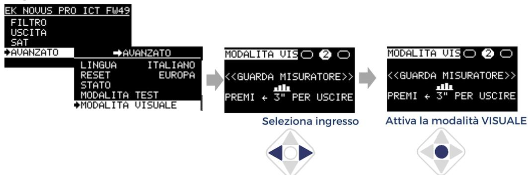
Attivando la modalità VISUAL con un clic centrale, il canale selezionato inizia a lampeggiare sul misuratore di campo, facilitando l'identificazione visiva. Utilizzando i tasti direzionali del joystick, è possibile modificare la frequenza, regolare il livello di uscita o rimuovere il filtro. Con un'altra pressione centrale, viene selezionato il canale di frequenza superiore successivo.
