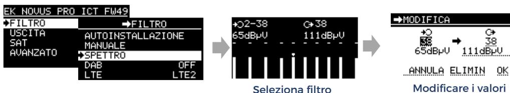
L'opzione SPECTRUM consente di eseguire le stesse azioni sui filtri dell'opzione MANUALE, con l'ulteriore vantaggio che, a colpo d'occhio, è possibile vedere tutti i filtri programmati e non è necessario selezionare l'ingresso. Si tratta semplicemente di una potente alternativa, che offre all'installatore la flessibilità di scegliere l'opzione che preferisce per la gestione dei filtri in base alle proprie esigenze.
