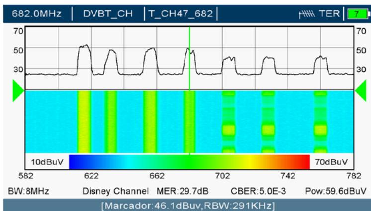
*Effetto di un fading, dove i tre canali alti soffrono variazioni di livello del loro segnale*
