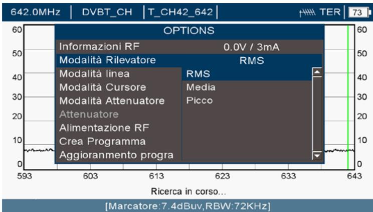
*Selezione del tipo di rilevatore di segnale RF*
