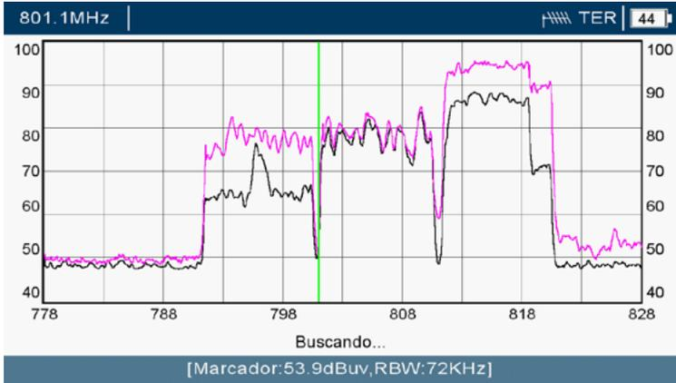
Misurazione in testa di un segnale interferente 4G. (Si osservano i canali di download)
