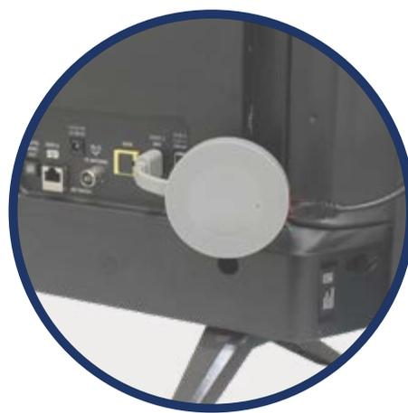
Dispositif CR 4K connecté à une télévision et à un réseau LAN câblé
