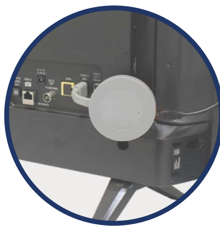
Dispositivo CR 4K conectado a un televisor y a la red LAN cableada
