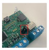
Per questa configurazione, è sufficiente collegare il Jumper in posizione verticale come indicato nello schema:
