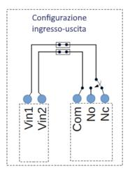
**Attenzione**: Si prega di notare che il CCA+ può essere alimentato indipendentemente dalla polarità di ingresso, ma il terminale Com di uscita è collegato all'ingresso Vin2 e il No/Nc al Vin1.
