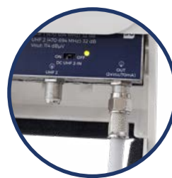
Indication de fonctionnement par LED
